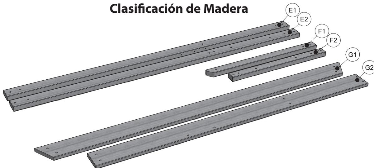
Durante la extracción de la madera de las cajas recomendamos ordenarlas por número de pieza antes de empezar el montaje. Esto permitirá mayor rapidez en el montaje e identificar fácilmente las piezas que pueden estar dañadas o faltantes.
